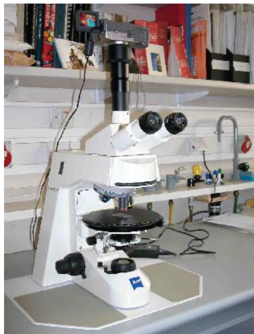
תרשים 3.5: מיקרוסקופ האור (מתוצרת Zeiss) ומעליו מצלמה דיגיטלית (מתוצרת Canon, דגם PowerShot G2) המורכבת באמצעות מתאם.
