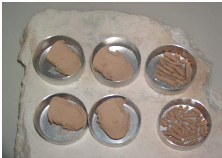
תמונה 3.4: דגימות קרקע לאחר בדיקות גבול נזילות וגבול פלסטיות ולאחר ייבוש בתנור.
