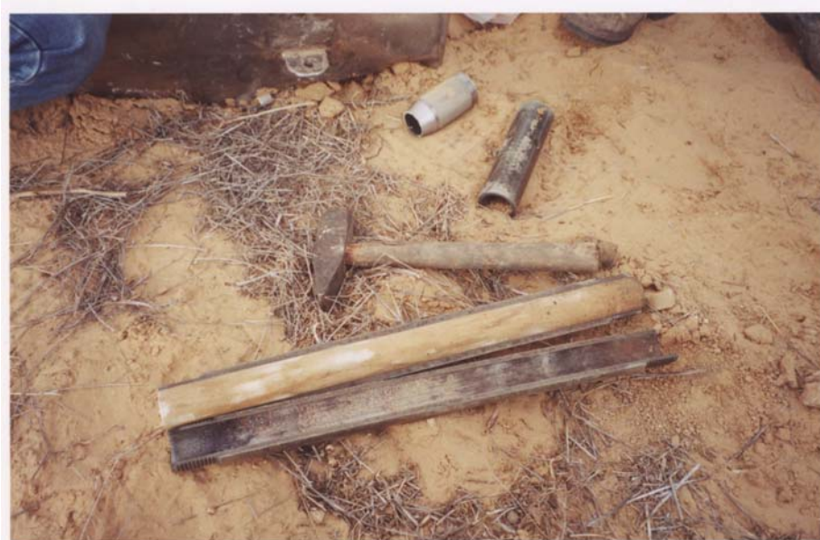
תמונה 3.2 : גליל קרקע בכף הדגימה לאחר בדיקת החדרה סטנדרטית .
