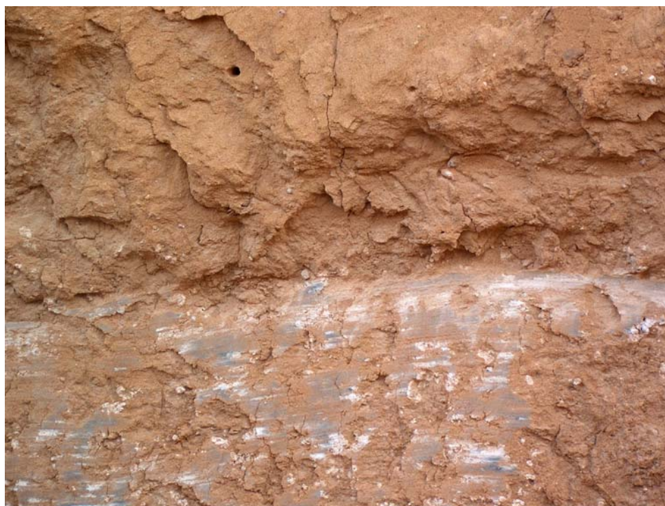
תמונה 4.1: קו המגע בין שכבת החול הסיילטי SM (למעלה) והחול החרסיתי SC (למטה) בדופן החתך של מחפורת II.
