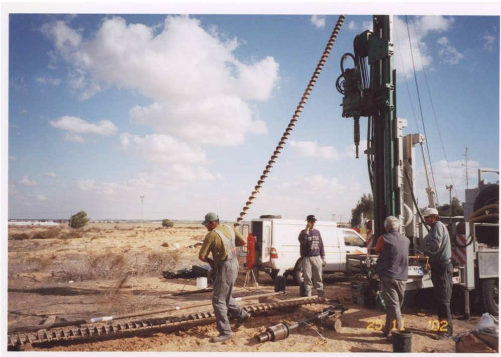
תמונה 3.1 : בדיקות שדה בשטח המחקר- בחזית קידוח מכין לבדיקת SPT ומאחור בדיקת פרסיומטר.
