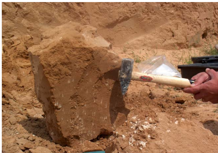
תמונה 3.3: סיתות בלוק של קרקע מטיפוס SP-SC שהוצא מהמחשוף בחתך של מחפורת II.
