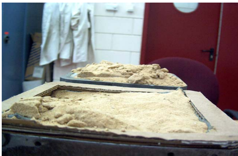
תמונה 5.1: פרופיל מישור הגזירה של דגם קרקע (S12) מטיפוס SP-SM מיד בתום בדיקת גזירה ישירה
