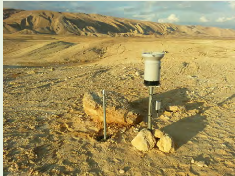
על רקע המצוקים היפייפים של מכתש גדול - אזור שעבר כרייה ומד גשם רושם (השולחן הודעות על גשם למייל ולסלולרי). ביניהם שטח שלא עבר כרייה.
