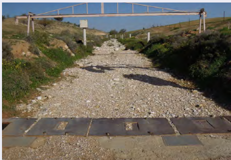
מבט כלפי מעלה נחל אשתמוע בתחנת המחקר, בה נראה חלק מהציוד הכולל פלטות (ביאופונים אקוסטיים), מלכודות גרופת ועמודים למדידת רום ושיפוי פני המים. התחנה כוללת 23 חיישנים לניטור אוטומטי.
