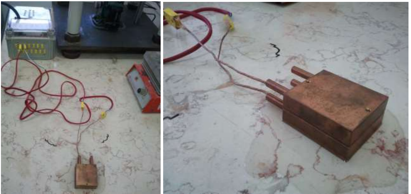
איור 10: מערכת הניסוי חוק האפס- שתי יחידות נחושת המחוברות לתרמוקפלים.
